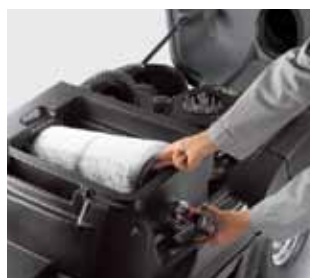
Prakticky – výmena filtra a valca bez použitia nástrojov
